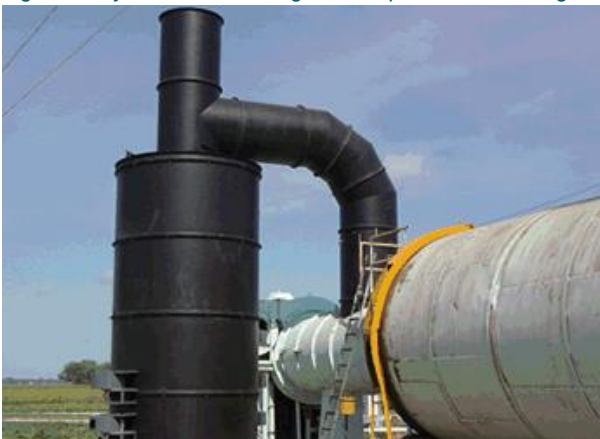
Figuur 10 Cycloonbrander aangesloten op een trommeldroger
