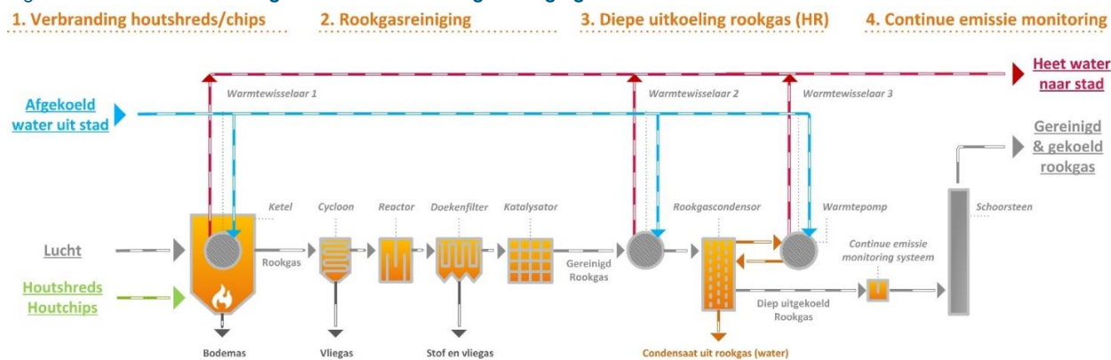
Figuur 12 Schematische weergave van ketel en rookgasreiniging
